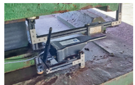
Sonderadaption 6D-Sensor an Brückenwiderlager (Preis auf Anfrage)
