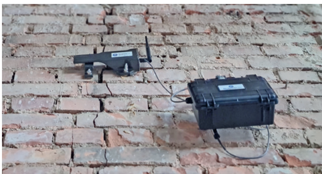
Einsatzbeispiel 6D-Sensor (S-100) mit Batteriekoffer (E-100)
